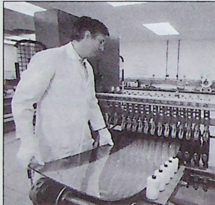
Vue du laboratoire SAFLEX où sont fabriqués des intercalaires pour verre feuilleté
