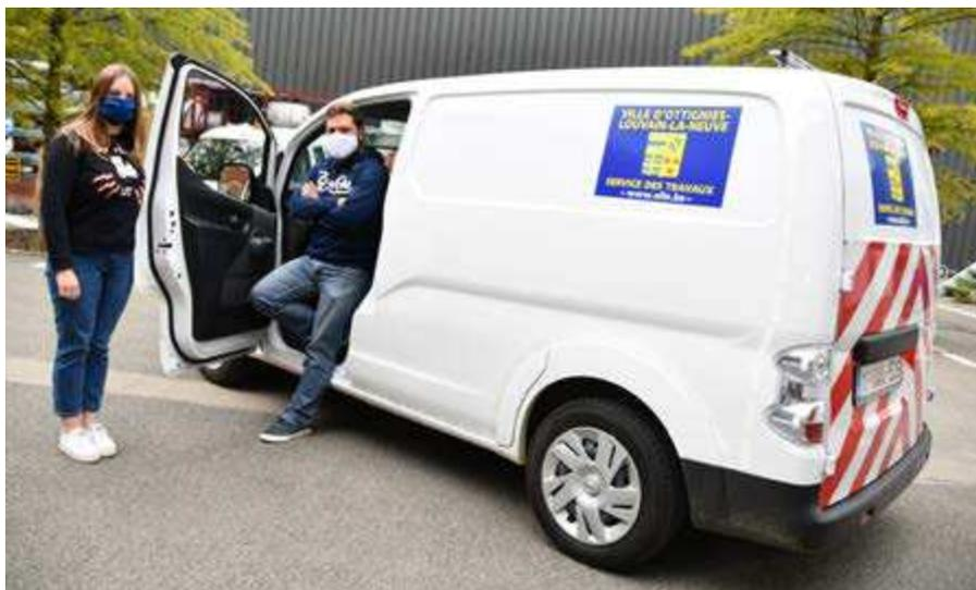
«Ce sont des véhicules de 109 chevaux, 80kW, avec une autonomie de 250km, dont la capacité du coffre permet de charger une palette de format européen (80x120cm)», détaille Thierry Marcoux, responsable de la Logistique au service Travaux. «Celui destiné aux missions Powalco est équipé d'un gyrophare et d'une signalisation adaptée pour des arrêts fréquents sur la voirie.»
